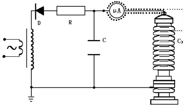
图 4-6b 排除试品  $C_x$  表面影响接线图
