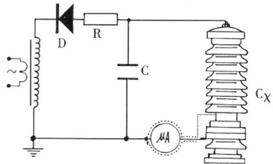
图 4-6d 排除试品  $C_x$  表面影响接线图
