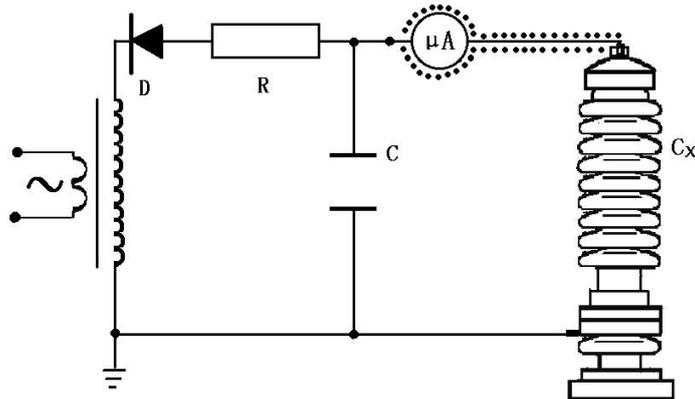
图 4-6a 微安表接入试品  $C_x$  高压侧接线图
