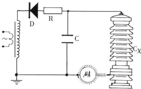
图 4-6c 微安表接入试品  $C_x$  底部接线图
